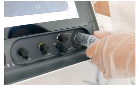
Canopy-Tests sind einfach in der Umsetzung. Der Canopy-Schlauch muss lediglich an das Gebläse angeschlossen werden.
